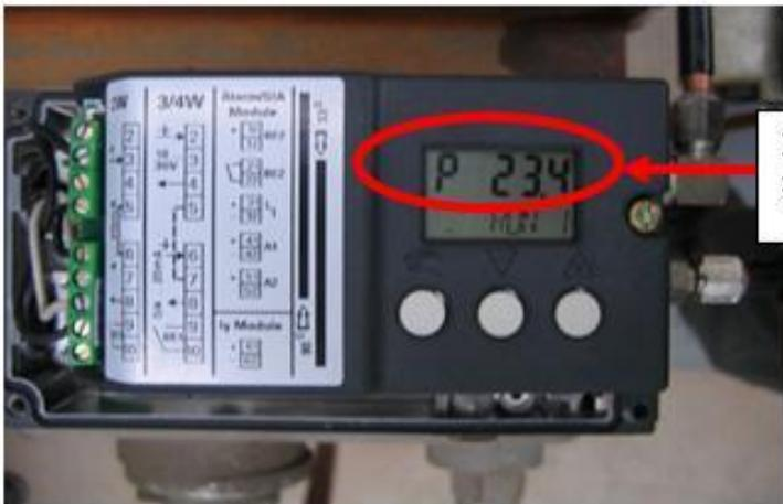
P后开度值不变，初始化第一步无法进行，检测气路没有问题
